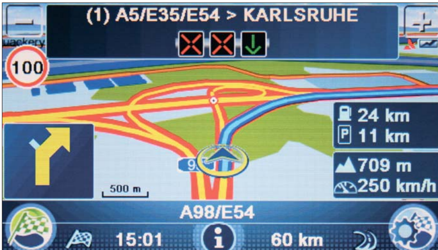
Fahrspurassistent und Tempolimit-Anzeige helfen insbesondere bei Autobahnfahrten
