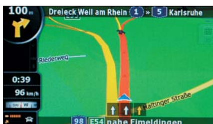
Der Fahrspur-Assistent zeigt am unteren Bildrand an, welche Spur zum Ziel führt
