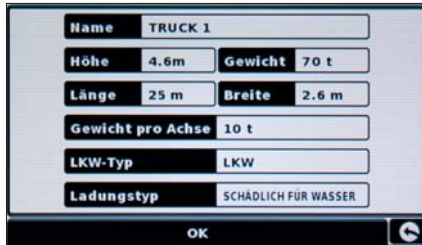
Die Daten des aktuellen Fahrzeugs lassen sich speichern und werden bei der Routenberechnung berücksichtigt
