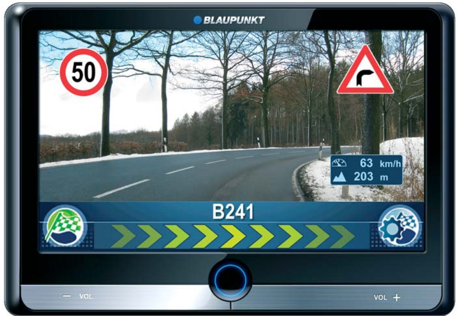
Das Blaupunkt TravelPilot 510 erkennt nun auch Überholverbotsschilder. Wichtiger ist aber noch der Kurvenwarner, der den Radius der Kurve aus dem Kartenmaterial berechnet und je nach aktueller Geschwindigkeit diese als gefährlich einschätzt.
