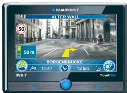
Eine Videokamera, einen DVB-T-Empfänger und ein Wireless-LAN-Modul hat das TravelPilot 700 zu bieten
