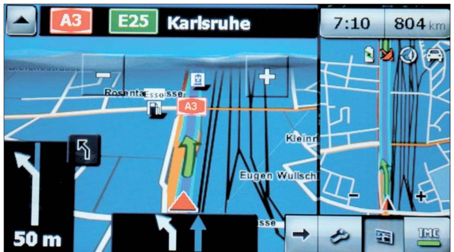
Die Geräte der F-Serie bieten auch einen Splittscreen-Modus, bei dem rechts eine Gesamtübersicht der Verkehrssituation zu sehen ist
