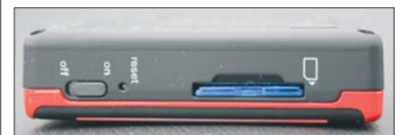
Der Hauptschalter, die Resetaste und der Speicherkarten-Steckplatz sind an der linken Seite zu finden
