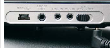
An der Unterseite befinden sich Mini-USB-Port, die Anschlüsse für Kopfhörer, TMC-Antenne und Mikrofon sowie der Hauptschalter
