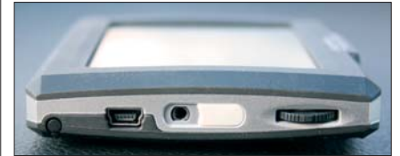
An der rechten Seite reihen sich der Zeigestift, der Mini-USB-Port (der gleichzeitig Stromanschluss ist), der Kopfhöreranschluss sowie der Lautstärkeregler aneinander
