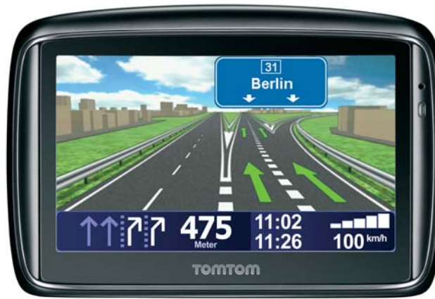
◀ Der TomTom Go 940 Live ist das Spitzenmodell des niederländischen Herstellers. Er kommuniziert über ein fest eingebautes GPRS-Modul mit dem Verkehrsleit-rechner und holt sich auf diese Weise ständig die aktuellsten Ver-kehrsinformationen.
