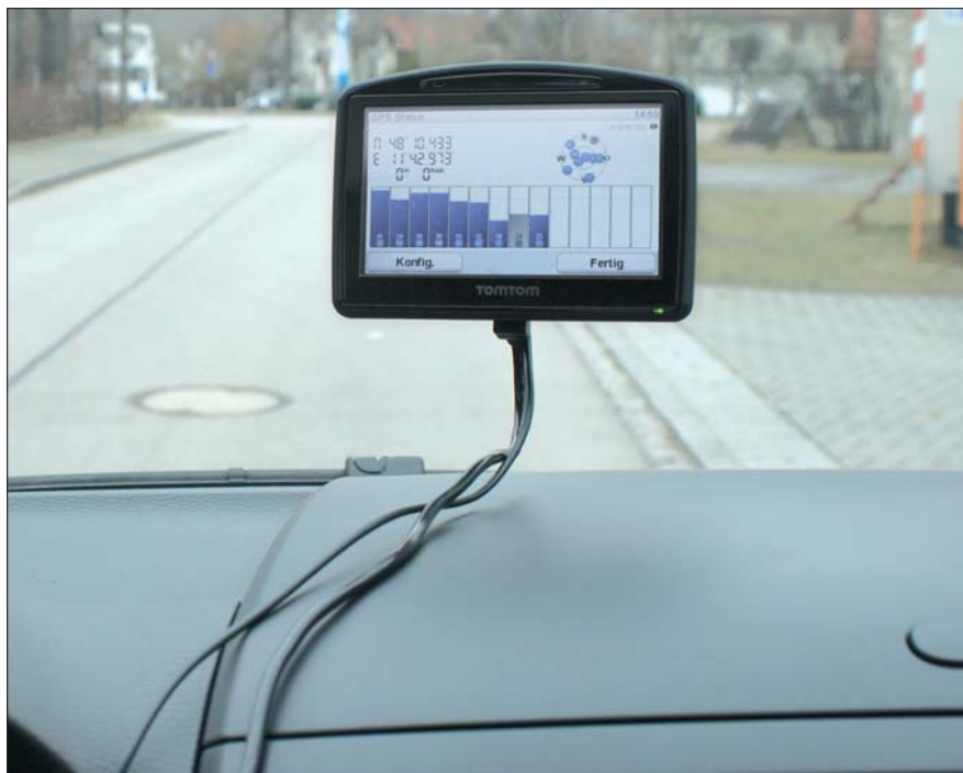
Nicht schön: Außer dem Stromkabel führt auch ein RG174 von der GPS-Antenne zum Navi. Wenn man noch TMC haben will, kommt ein drittes Kabel dazu.
