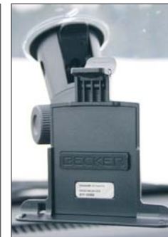
◀ Zum Lieferumfang gehört eine Passiv-Halterung, die für einen sicheren Halt an der Windschutzscheibe sorgt
