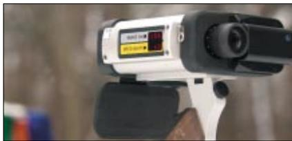
**Ein Handlaser neuester Bauart zeigt die Länge der geprüften Strecke und die tatsächliche Übertretung mit bereits abgezogener Toleranz. Gegen so etwas hilft nur das Einhalten der Tempolimits.**
