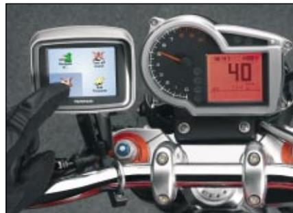
Speziell für Motorradfahrer konstruiert ist der Rider. Im Motorradmodus verringert sich beispielsweise die Zahl der Bedientaste pro Bildschirmseite von sechs auf vier.
