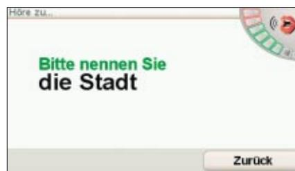
TomTom - Schritt 2: Das Symbol oben rechts signalisiert, dass das TomTom-Gerät auf die Spracheingabe des Stadtnamens wartet.
