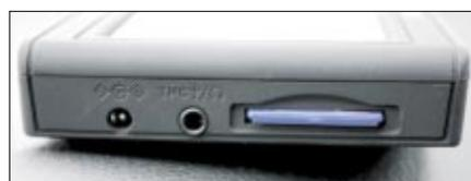
An der rechten Seite befinden sich der Stromanschluss, die Buchse für den Kopfhörer und die TMC-Antenne sowie der Speicherkarten-Steckplatz
