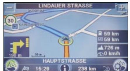
*Das Tempolimit-Schild links oben hat die eingebaute Videokamera erfasst - was am Kamera-Symbol zu erkennen ist*
