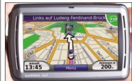
**Die Sprachsteuerung beim Garmin Nüvi 860 T lässt sich mittels Funkfernbedienung aktivieren**
