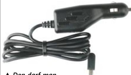
▲ **Den darf man nicht abschneiden und direkt anklammern. Kein aktuelles Navi kann die 12 Volt PKW-Bordspannung direkt verarbeiten. Wenn man den Spannungsregler im Zigarettenanzünderstecker umgeht, wird das Navi gebraten.**
