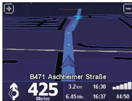
*Im Nachtmodus wird das Display massiv abgedunkelt, damit der Fahrer nicht geblendet wird. Eine Automatik gibt's leider nicht, das muss man von Hand umschalten.*
