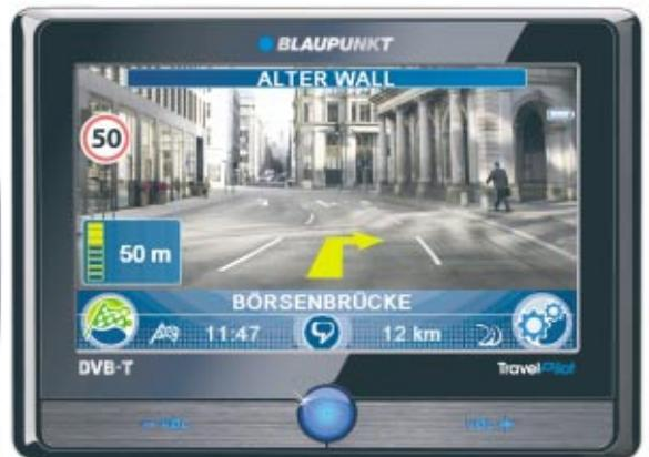
Das TravelPilot 700 ist mit einer Videokamera, einem DVB-T-Empfänger und einem Wireless-LAN-Modul ausgestattet
