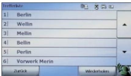
**Falk - Schritt 4:** Das Gerät gleicht die Phonetik mit den Listeneinträgen ab und zeigt mögliche Treffer an.
