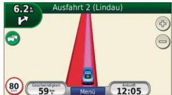
In einem Tunnel gibt es keinen GPS-Empfang, daher errechnet das Nüvi die aktuelle Position anhand der zuletzt gefahrenen Geschwindigkeit
