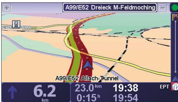
Die Modelle Go 920 und Go 930 sind mit einem Sensor ausgerüstet, der die aktuelle Fahrzeugposition auch in Tunnels richtig bestimmen können soll. Dass EPT arbeitet, sieht man an dem roten Logo rechts unten.
