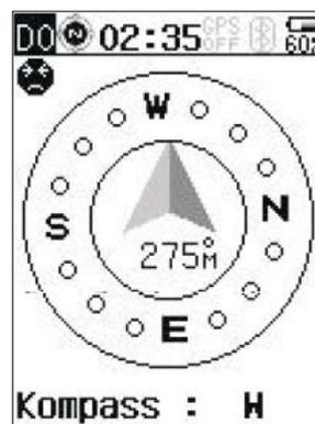
Der WSG-1000 hat auch einen elektromagnetischen Kompass eingebaut
