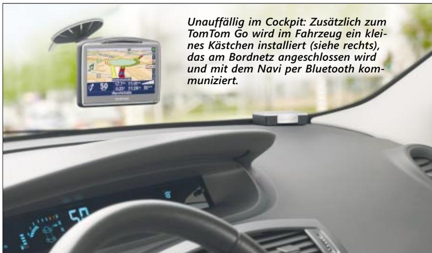
Unauffällig im Cockpit: Zusätzlich zum TomTom Go wird im Fahrzeug ein kleines Kästchen installiert (siehe rechts), das am Bordnetz angeschlossen wird und mit dem Navi per Bluetooth kommuniziert.
