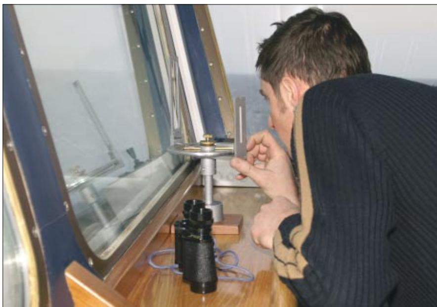
Seitenpeilung mittels Peilscheibe an eine Landmarke. Auch damit lässt sich die eigene Position feststellen. Im GPS-Zeitalter ist diese Methode jedoch überflüssig geworden.
