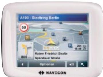
Das Navigon 5110 verfügt über ein 3,5-Zoll-Display mit einer Auflösung von 320 mal 240 Bildpunkten ▶
