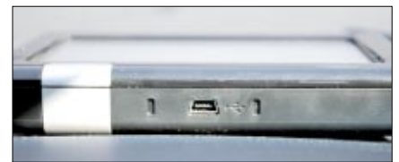
An der Unterseite verfügen beide Geräte über einen Mini-USB-Port, an dem sich auch das Ladekabel anschließen lässt
