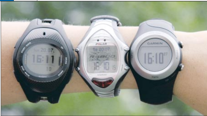
◀ Drei digitale Trainingspartner mit ausgefeilten Funktionen (von rechts nach links): Garmin Forerunner 405, Polar RS800G3 und Suunto X9i. Die mittlere Uhr ist die kleinste, da sie als einzige keinen internen GPS-Empfänger aufweist.
