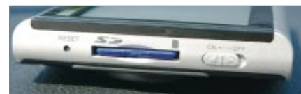
Links befinden sich die Reset-Taste, der Speicherkarten-Steckplatz und der Hauptschalter
