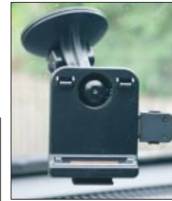
◀ Garmin liefert das Nüvi 5000 mit einer Aktivhalterung aus, an der das Ladekabel angesteckt wird
