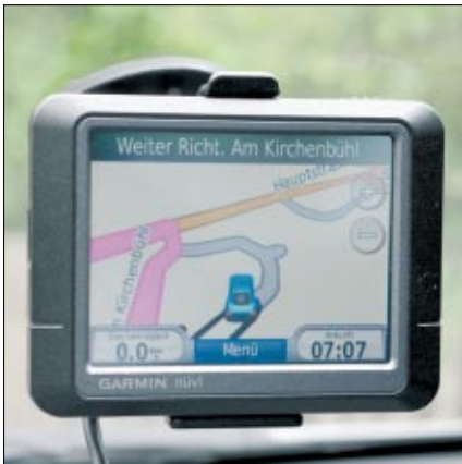
Die neueste Software-Version zeigt links oben einen Richtungspfeil und die Entfernung zur nächsten Fahraktion
