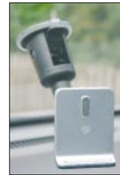
◀ Magnete fixieren das Navi in der Halterung für die Windschutzscheibe
