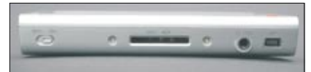
An der Unterseite befinden sich der Hauptschalter, der Speicherkarten-Steckplatz, der Kopfhöreranschluss und ein Mini-USB-Port
