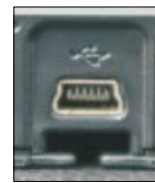
Über den Mini-USB-Port an der Unterseite fließen wahlweise Daten oder Strom
