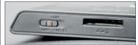
An der Oberseite befinden sich der Ein-/Ausschalter sowie der Steckplatz für eine Speicherkarte
