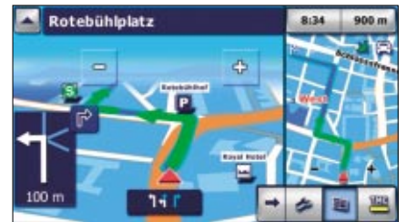
Auf Wunsch lässt sich der Bildschirm während der Navigation splitten: Links die aktuelle Verkehrssituation, rechts die Übersichtskarte
