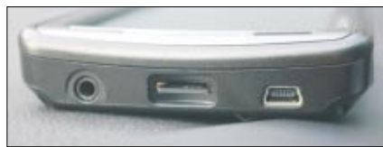
An der linken Seite befinden sich der Kopfhöreranschluss, der Speicherkarten-Steckplatz und der Mini-USB-Port
