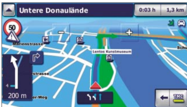
Der klassische Bildaufbau: Links die Richtungspfeile, oben die Informationen und unten in der Mitte der Fahrspurassistent
