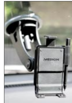
◀ Eine Besonderheit bei der Halterung der beiden Medion-Navis ist der integrierte Zeigstift
