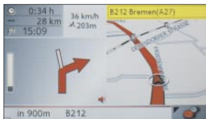
Im Splitterscreen-Modus sind links die Informationen und der Richtungspfeil platziert, rechts die Kartendarstellung
