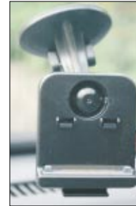
◀ Mit zum Lieferumfang gehört eine Aktiv-Halterung, die mit dem Lade- und TMC-Kabel verbunden wird
