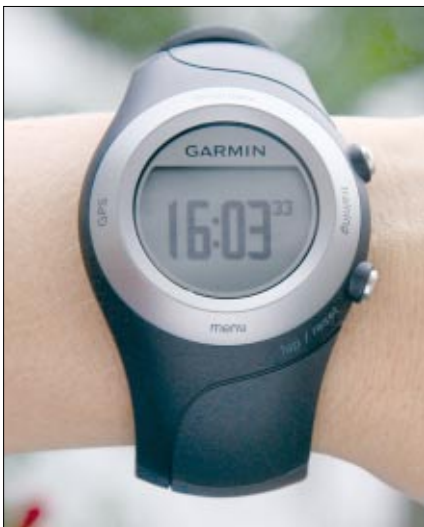
Beim kompakten, dezent designten Garmin Forerunner 405 erfolgt ein Großteil der Bedienung über den kapazitiven Rand rund ums Display. Das erfordert etwas Gewöhnung.
