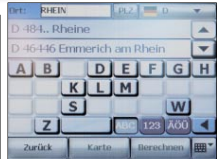
In der virtuellen Tastatur erscheinen nur jene Buchstaben, die für die weitere Eingabe sinnvoll sind
