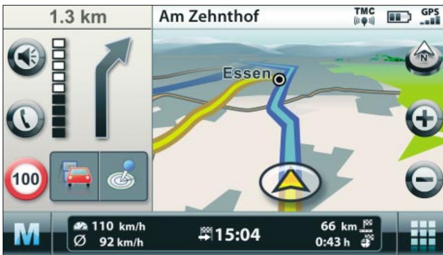
Sehr sinnvoll lässt sich das Widescreen-Display nutzen: Links ein Pfeil für die nächste Fahrhinweisung, rechts der aktuelle Kartenausschnitt
