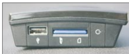
An der rechten Seite sind ein Standard-USB-Port, der Speicherkarten-Steckplatz sowie der Ein-/Ausschalter platziert
