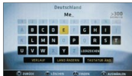
Bei der Eingabe von Orts- und Straßennamen blendet die Software nicht sinnvolle Buchstaben automatisch aus
