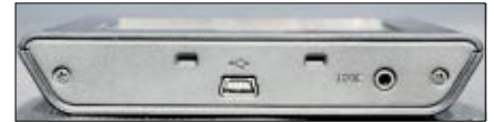
An der Unterseite befinden sich der Mini-USB-Port, der auch der Stromversorgung dient, und der Anschluss für die TMC-Antenne
