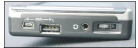
Der Standard-USB-Port ermöglicht den direkten Anschluss eines USB-Speichersticks mit Multimedia-Dateien
