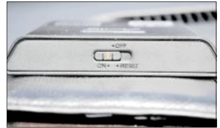
Einziges Bedienelement neben dem Touchscreen-Display ist der Ein-/Aus-schalter an der Oberseite
