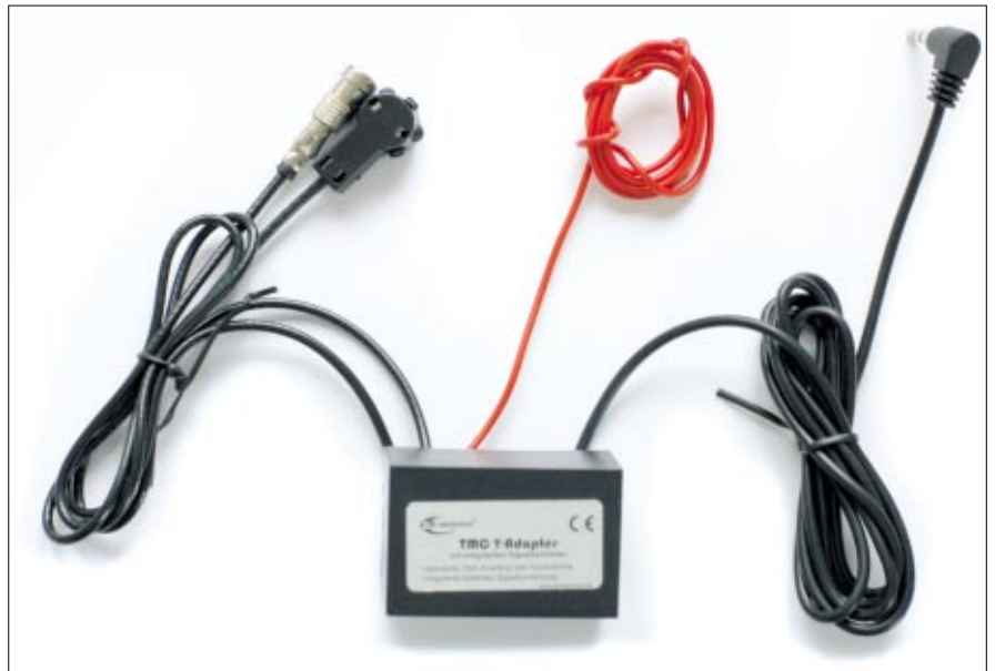
Wesentlich größer als das Modul von GNS ist der TMC-Y-Adapter von Ge-Tectronic. Deswegen ist es durchaus sinnvoll, dass dieses längere Antennenkabel hat.
