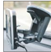
◀ Zwei feststellbare Gelenke sorgen dafür, dass sich der TravelPilot 200 frei ausrichten lässt
