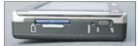
Die Reset-Teste und der Hauptschalter sind unterhalb des Speicherkarten-Steckplatzes zu finden
