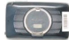
Gut zu erkennen sind hier die Kontakte an der futuristischen Halterung, über die die Stromversorgung erfolgt und die TMC-Meldungen ankommen
