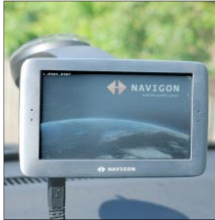
Gut zu erkennen sind hier die Kontakte an der futuristischen Halterung, über die die Stromversorgung erfolgt und die TMC-Meldungen ankommen
