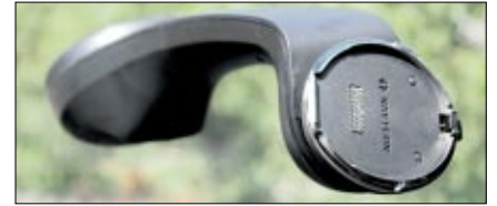
Gut zu erkennen sind hier die Kontakte an der futuristischen Halterung, über die die Stromversorgung erfolgt und die TMC-Meldungen ankommen
