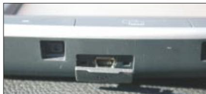
Hinter einer Gummilase ist der Mini-USB-Port positioniert, der auch als Stromanschluss dient
