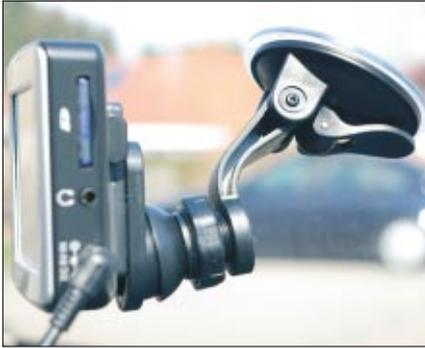
Beim MyGuide 3100 sorgen zwei feststellbare Gelenke dafür, dass sich das Gerät beliebig ausrichten lässt
