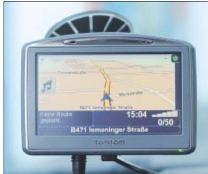
Das Flaggschiff von TomTom ist der Go 920T. Deutlich erkennt man unten in der Mitte den Ladestecker und links davon den Anschluss des externen TMC-Empfängers.
