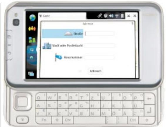
Die herauschiebbare Tastatur des Nokia N810 wartet sogar mit eigenen Tasten für die deutschen Umlaute auf. Die obersten Tasten liegen etwas zu nahe am Gehäuserand.
