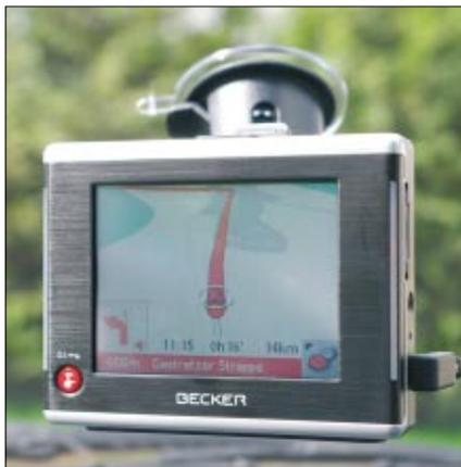
*Beim Traffic Assist 7927 ist ein 3,5-Zoll-Display mit einer Auflösung von 320 mal 240 Bildpunkten eingebaut*
