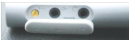
Hinter einer Gummi-Lasche sind die Anschlüsse für eine externe Antenne, Mikrofon und Lautsprecher versteckt
