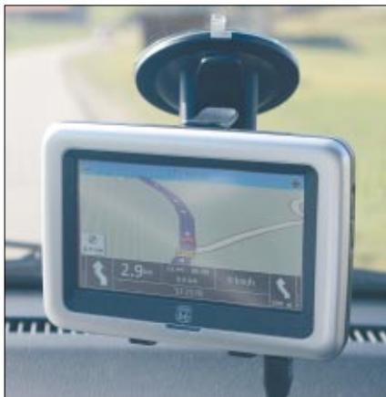
Der Chicago 9000 verfügt über ein Widescreen-Display mit einer Auflösung von 480 mal 272 Bildpunkten
