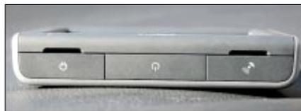
An der Oberseite befindet sich in der Mitte der Ein-/Aushalter, rechts und links davon sind unter Abdeckungen die Anschlüsse platziert
