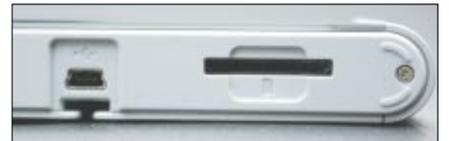
Mini-USB-Port und Speicherkarten-Steckplatz sind an der Unterseite platziert
