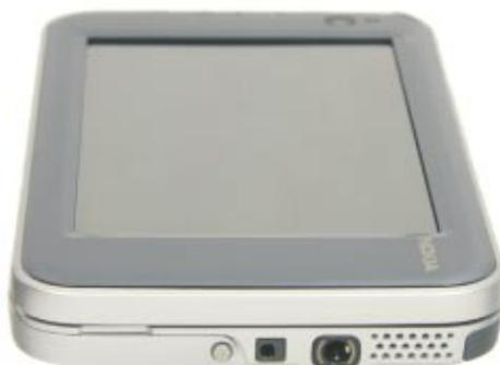
*▲ An der rechten Seite des Internet-Tablets liegen die Ladebuchse, die Kopfhörer-Buchse sowie einer der beiden Stereo-Lautsprecher*
