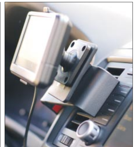
Deutlich erkennt man den zweiteiligen Aufbau: Unten drin sitzt der ProClip, der bis zur 6 mal 8 cm großen Grundplatte geht. Auf diese wird dann die gerätespezifische Halterung geschraubt, hier der Garmin-typische Kugelkopf.
