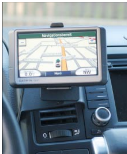
Die fahrzeugspezifischen ProClip-Halterungen werden in Spalten des Armaturenbretts fixiert. Je nach Fahrzeugtyp gibt es bis zu sechs mögliche Einbaupositionen.
