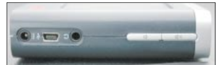
Seitlich befinden sich Strom- und Kopfhörer-Anschluss, Mini-USB-Port und Tasten für die Lautstärke-Regelung
