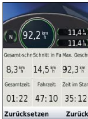
Der Trip-Computer führt Buch und errechnet die Durchschnittsgeschwindigkeit, die Zeit im Stand und vieles weitere
