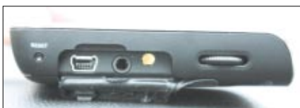
Hinter einer Gummilasche an der Seite sind die Anschlüsse platziert
