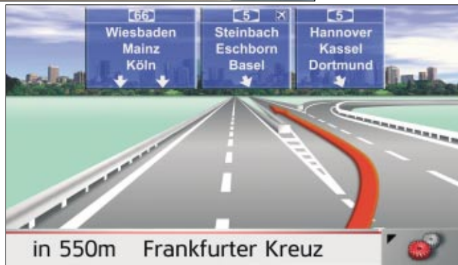
Im Reality-View-Modus zeigt das Traffic Assist 7928 eine wirklichkeitsgetreue Darstellung von Autobahn-Verzweigungen
