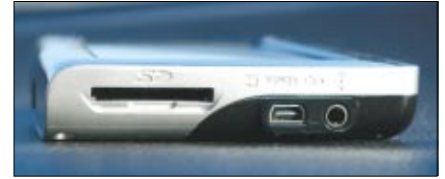
An der rechten Seite sind der SD-Card-Steckplatz, der Mini-USB-Port und der TMC-Antennenanschluss platziert
