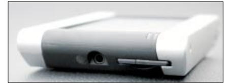
Seitlich sind ein Kopfhörer-Anschluss und der Speicherkarten-Steckplatz platziert
