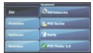
Große Schaltflächen erleichtern die Bedienung mit dem Finger und verhindern Fehl Eingaben
