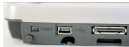
An der Unterseite befinden sich die Reset-Taste, der Mini-USB-Port und die Kontaktleiste für die Halterung
