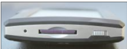
An der linken Seite sind der Speicherkarten-Steckplatz und der Hauptschalter platziert
