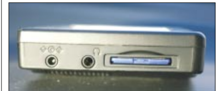
Strom- und Kopfhörer-Anschluss sowie der Speicherkarten-Steckplatz sind an der rechten Seite platziert
