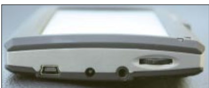
USB-Port, Strom- und Kopfhörer-Anschluss sowie Lautstärkereglер sind rechts zu finden
