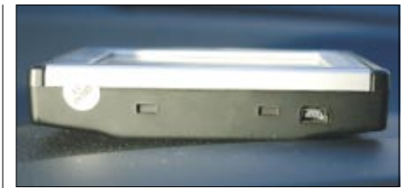
Kerben zum Einrasten der Halterung sowie ein Mini-USB-Port befinden sich an der Unterseite
