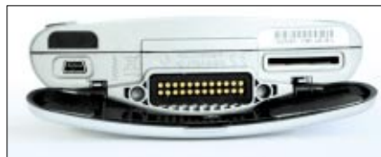
USB-Port und Speicherkarten-Steckplatz verschwinden während der Fahrt hinter einer Schutzklappe
