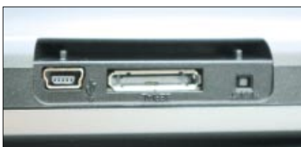
Die Reset-Taste, eine serielle Schnittstelle und ein Mini-USB-Port sind an der Unterseite zu finden
