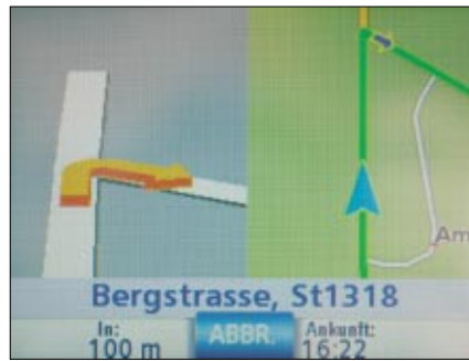
Kurz vor dem Abbiegen teilt sich beim Magellan-Gerät der Bildschirm, und links ist ein vergrößerter Richtungspfeil zu sehen
