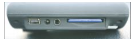
Seitlich befinden sich die Anschlüsse und der Speicherkarten-Steckplatz
