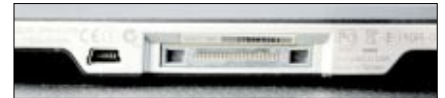
An der Unterseite des Gerätes befinden sich neben dem Mini-USB-Port die Kontakte für die Halterung ▼
