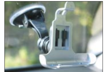
▲ Die Halterung für die Windschutzscheibe besteht aus zwei Kunststoffteilen
