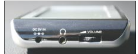
An der rechten Seite sind der Strom- und der Kopfhöreranschluss sowie der Lautstärkereglert platziert
