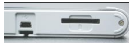
Mini-USB-Port und Speicherkarten-Steckplatz sind an der Unterseite platziert
