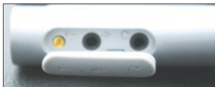
Hinter einer Gummi-Lasche sind die Anschlüsse für eine externe Antenne, Mikrofon und Lautsprecher versteckt
