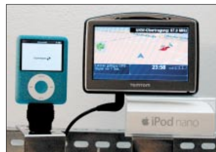
In dieser Einstellung werden alle Töne des TomTom über UKW an ein Autoradio oder an einen Radioempfänger im Haus übertragen. So klingt die Musik aus dem iPod gleich viel besser als aus dem TomTom-Mono-Lautsprecher.
