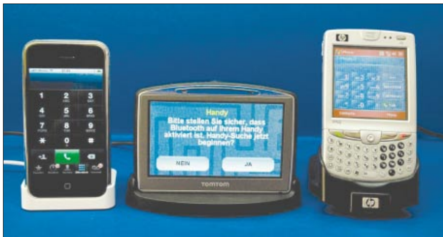
Handys wie das iPhone links und der iPaq rechts können den TomTom Go 720 dank Bluetooth als Freisprechanlage nutzen. So können die Handys in der Tasche bleiben. Gespräche werden am TomTom-Display abgenommen und aufgelegt.
