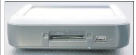
An der Unterseite befinden sich der Speicherkarten-Steckplatz und der Mini-USB-Port
