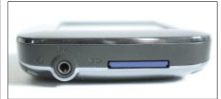
Seitlich sind der Anschluss für die TMC-Wurfantenne sowie der Speicherkarten-Slot platziert
