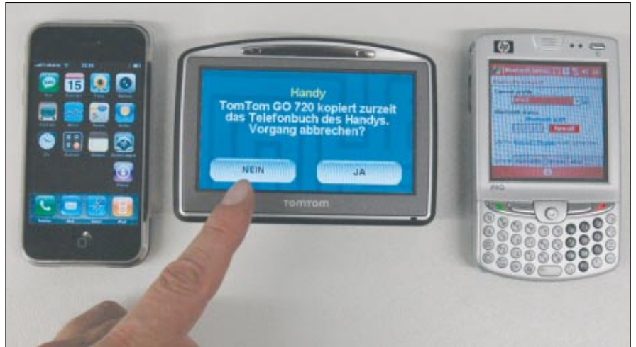
Das Telefonbuch des Apple-Handys hat sich der TomTom hier schon via Bluetooth reingezogen. Jetzt ist gerade das HP-Handy dran. Der TomTom merkt sich, welches Telefonbuch zu welchem Handy gehört.
