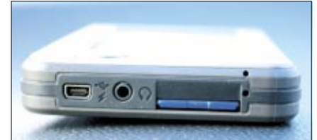
▲ Seitlich befinden sich der Mini-USB-Port, der Kopfhöreranschluss und der Speicherkarten-Steckplatz
