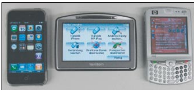
Hier ist das iPhone mit dem TomTom gekoppelt. Tippen wir auf das blaue Handy in der Mitte, so wird das iPhone abgekoppelt und der HP-iPaq angekoppelt. Über »Verbindung löschen« können wir Handys auch dauerhaft löschen.
