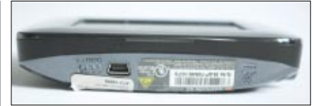
An der Unterseite des Gerätes befindet sich lediglich der Mini-USB-Port, über den auch die Stromversorgung erfolgt
