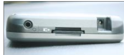
Kopfhöreranschluss, Speicherkarten-Steckplatz und Stromanschluss sind seitlich platziert
