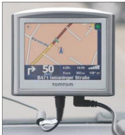
Rechts unten führt das Ladekabel zum Zigarettenanzünder. Das Kabel links ist vom TMC-Empfänger, dessen Elektronik in dem ovalen Ei sitzt.
