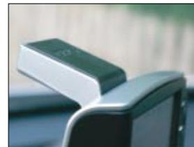
◀ **Herausragend:** Die GPS-Antenne an der Rückseite lässt sich aufklappen, was den Empfang verbessert.
