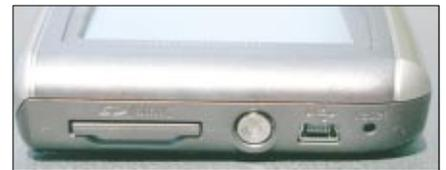
**Links reihen sich der Speicherkarten-Steckplatz, der Ein-/Ausschalter, die USB-Buchse und die Resettaste aneinander**
