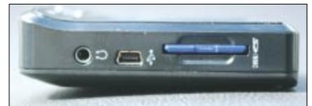
An der rechten Seite befinden sich der Kopfhöreranschluss, der Mini-USB-Port und der Speicherkarten-Steckplatz
