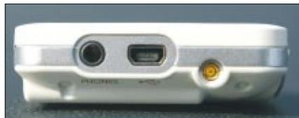
*Kopfhöreranschluss, Mini-USB-Port für das Ladekabel und ein externer Antennenanschluss sind an der rechten Seite platziert*
