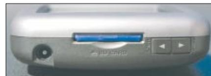
Stromanschluss, Speicherkarten-Steckplatz und zwei Bedientasten befinden sich auf der linken Seite
