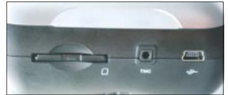
Speicherkarten-Steckplatz, TMC-Anschluss und Mini-USB-Port sind an der linken Seite zu finden
