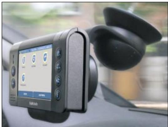
◀ **Praktisch alle Navigeräte werden mit einem Saugnapf an der Frontscheibe befestigt. Der Zubehörhandel bietet aber viele alternative Halterungen, teilweise individuell auf den Fahrzeugtyp abgestimmt.**
