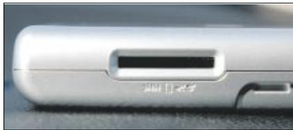
**An der Oberseite des Gerätes befindet sich der Steckplatz für eine Speicherkarte**
