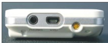
*Kopfhöreranschluss, Mini-USB-Port für das Ladekabel und ein externer Antennenanschluss sind an der rechten Seite platziert*
