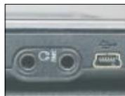
◀ An der linken Seite sind die Anschlüsse für einen Kopfhörer und die TMC-Antenne sowie ein Mini-USB-Port platziert
