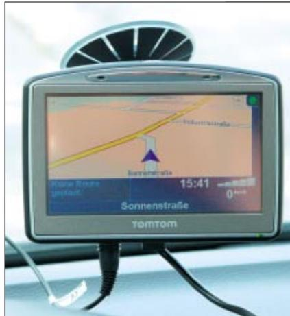
◀ In der Mitte erkennt man das Stromkabel, das Kabel links führt zum TMC-Empfänger
