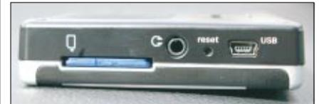
Speicherkarten-Steckplatz, Kopfhöreranschluss, Resettaste und Mini-USB-Port befinden sich auf der rechten Seite
