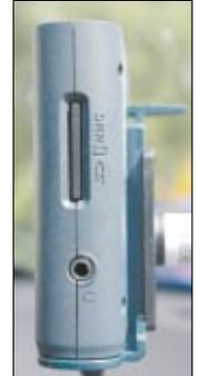
An der Oberseite sind der Ein-/Ausschalter sowie der Anschluss für eine externe Antenne zu finden ▼
