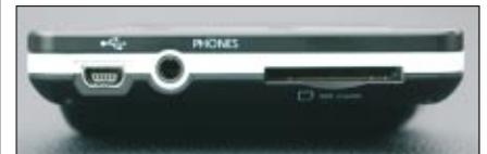
An der rechten Seite sind der Mini-USB-Port, der Kopfhöreranschluss sowie der Speicherkarten-Steckplatz zu finden
