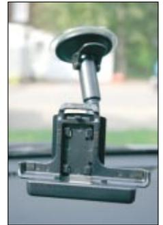
*Mittels Schwannenhals verbindet die Halterung das GPS 280 mit dem Saugnapf an der Windschutzscheibe ▶*
