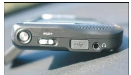
Links sind der Ein-/Aus- sowie ein Verriegelungsschalter, die USB-Buchse sowie der Kopfhörer-Anschluss platziert
