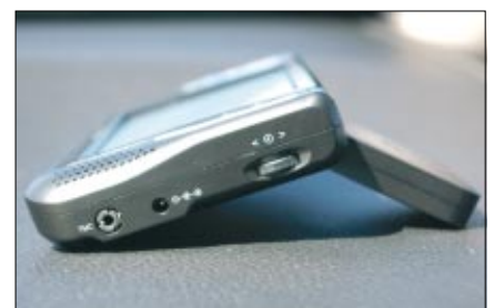
An der rechten Seiten befinden sich die Anschlüsse für die TMC-Antenne und das Ladekabel sowie der Lautstärkereglern
