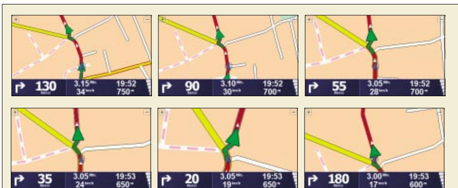
Sehr gut sieht man hier den automatischen Zoom der TomTom-Navigationssoftware: Je näher wir an die nächste Kreuzung kommen, desto größer wird diese etwas unübersichtliche Kreuzung dargestellt. Haben wir sie passiert (letztes Bild), stellt sich der Maßstab wieder auf normal zurück. Würden wir der gelb eingezeichneten Straße folgen, bleibt der Zoom natürlich auf dem Anfangsmaßstab.
