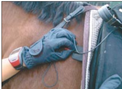
Eine per Kabel mit dem Brustgurt verbundene EKG-Elektrode wandert unter den Sattel am Rücken des Pferdes
