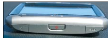
An der Oberseite befinden sich der Ein-/Ausschalter sowie, unter Abdeckungen versteckt, die Anschlüsse für eine externe GPS-Antenne und für Kopfhörer
