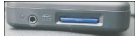
An der rechten Seite sind der Steckplatz für die SD-Card mit dem Kartenmaterial und der Kopfhörer-Anschluss zu finden
