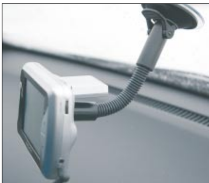
Die GPS-Antenne lässt sich nach hinten ausklappen - doch das half bei den Empfangsproblemen nichts
