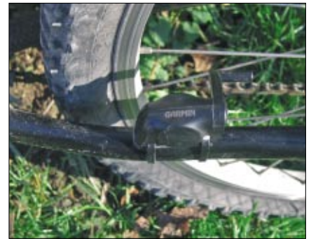
Dieser Sensor nimmt gleichzeitig die Trittfrequenz des Pedals und die Drehgeschwindigkeit des Hinterrads wahr - und schickt sie per Funk an den Edge 305
