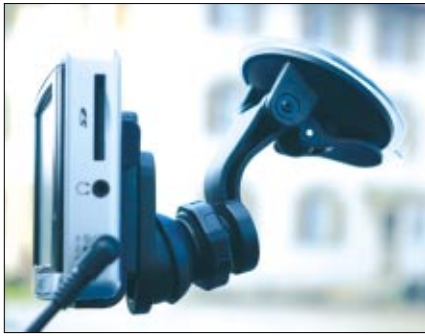
Die Halterung für die Windschutzscheibe ist recht kurz - das kann in Vans und LKWs durchaus ein Problem sein
