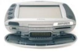
Hinter einer Klappe an der Unterseite sind der USB-Port und der Speicherkarten-Steckplatz zu finden ▲
