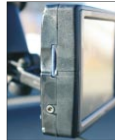
◀ An der linken Seite befinden sich der Steckplatz für die Speicherkarte und ein Kopfhörer-Anschluss
