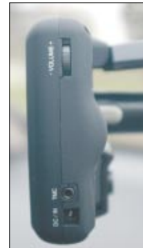
◀ An der rechten Seite sind der Lautstärkeregler, die Buchse für ein externes TMC-Modul sowie der Stromanschluss platziert
