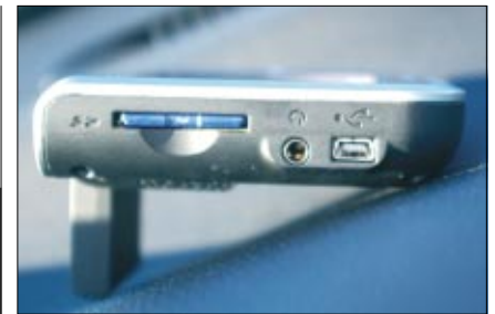
Der Blick von der Seite zeigt den Speicherkarten-Steckplatz, den Kopfhörer-Anschluss sowie den USB-Port
