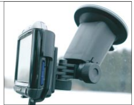
Sicher an der Windschutzscheibe fixieren lässt sich das p630 mit der mitgelieferten Halterung
