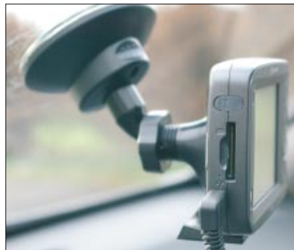
An der linken Seite sind ein zusätzlicher Antennenanschluss, der Speicherkarten-Steckplatz und der USB-Port platziert ▼
