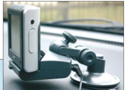
▲ Die neuartige Halterung ermöglicht die Befestigung auf dem Armaturenbrett
