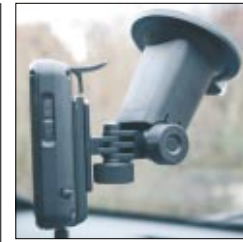
◀ Die Halterung rückt das Gerät nahe an die Windschutzscheibe - in Vans und LKWs kann das zum Problem werden
