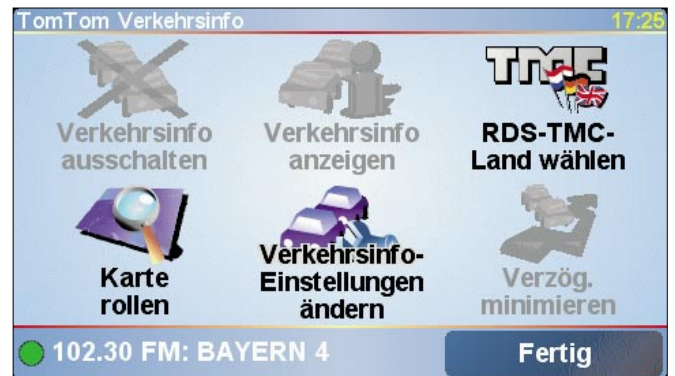
Das dürfte eigentlich nicht passieren: Es gibt zwei Möglichkeiten zur Sicherstellung, dass nur TMC-Sender berücksichtigt werden. Der TMC-Empfänger für den Go nutzt leider keine davon. Der Bayerische Rundfunk hat uns schriftlich bestätigt, dass Bayern 4 keinerlei TMC überträgt.
