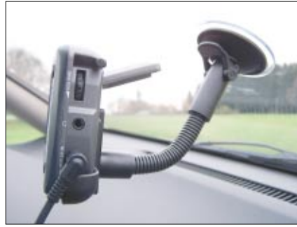
Der Blick von der Seite zeigt die ausgeklappte GPS-Antenne, den Lautstärkeregler, die Anschlüsse sowie die Halterung für die Windschutzscheibe
