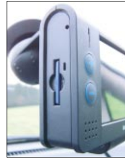
◀ An der linken Seite ist der Steckplatz für die SD-Card platziert, auf der sich das Kartenmaterial befindet
