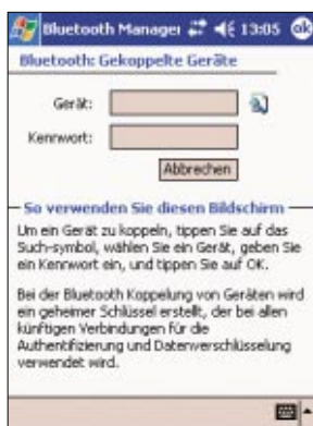
Den Bluetooth-GPS-Empfänger koppeln wir mit dem Pocket-PC - so verbinden sich die beiden Geräte immer automatisch, wenn sie an sind
