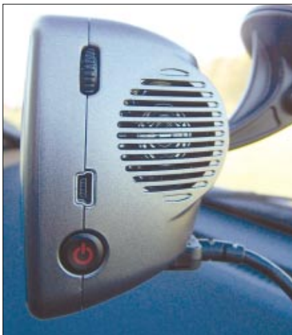
Der Blick an die rechte Seite zeigt den Lautstärkeregler, den USB-Port und den Ein-/Ausschalter
