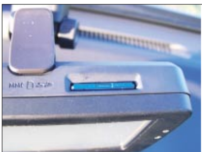
An der Oberseite ist der Steckplatz für die Speicherkarte zu finden, die das Kartenmaterial enthält
