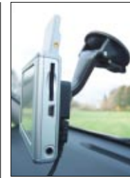
Der Blick von der Seite zeigt die ausgeklappte GPS-Antenne, den SD-Card-Steckplatz, die Anschlüsse und die Halterung für die Windschutzscheibe
