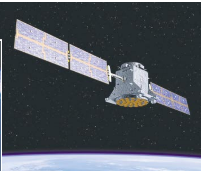
Ein GPS- oder Galileo-Satellit kann eigentlich nur senden. Um Daten an ihn zu übertragen, brauchen Sie schon eine ausgewachsene Bodenstation mit richtig großer Parabolantenne. Es ist also völlig ausgeschlossen, dass Ihr GPS-Modul Bewegungsdaten an die Satelliten überträgt.
