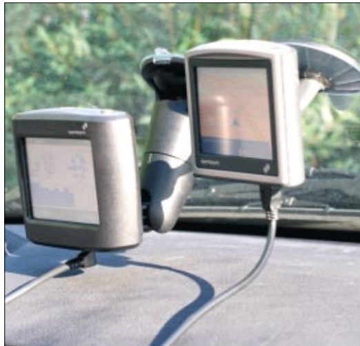
Ohne Kabel geht's nicht: Das Ladekabel zum Zigarettenanzünder braucht man praktisch immer. Die eingebauten Akkus halten je nach Gerät zwischen zwei und sechs Stunden.
