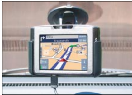
Die zwei Gelenke der Halterung ermöglichen eine Fixierung des Gerätes in nahezu jeder gewünschten Position ▶
