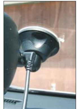
▲ Die Anschlüsse für Strom, Mikrophon und Lautsprecher sind in die Halterung integriert
