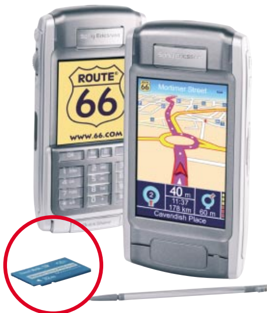
▲ Das Kartenmaterial der Route-66-Software findet auf einem Memory Stick Pro Duo Platz
