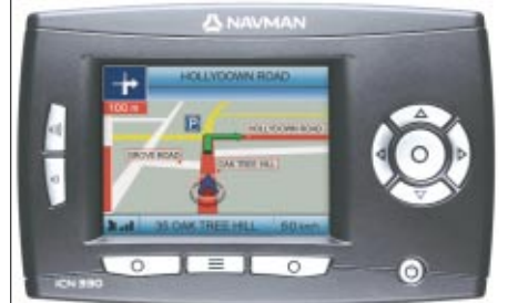
Der Blick von vorn zeigt die Bedienelemente rund um das Display - und auf dem Bildschirm die 3D-Darstellung während der Navigation
