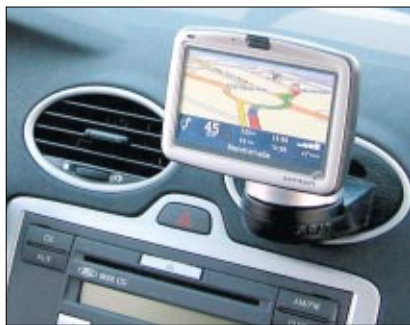
Hier ein TomTom Go im Ford: Deutlich erkennt man die Befestigung am Luftauslass der Lüftung.
