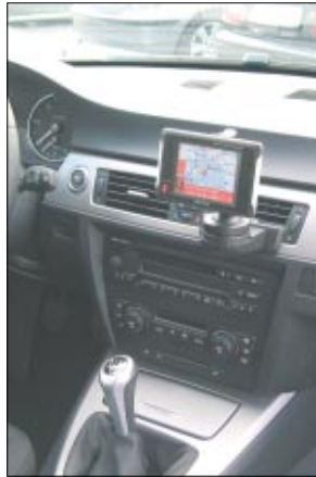
Ein Becker-Navigationsgerät im 1er BMW. Auch hier wurde ein fahrzeugspezifischer Haltefuß verwendet, auf den dann die Halterung des Navigationsgeräts gesetzt wird.
