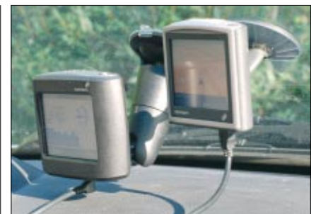
In der Kürze liegt nicht immer die Würze: Der extrem kurze Haltefuß des neuen One reduziert zwar Vibrationen, ist aber in vielen PKWs einfach zu kurz.
