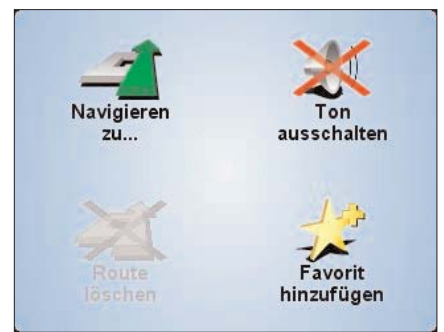
Wenn das Rider 2nd Edition in der Motorradhalterung steckt, schaltet es auf einen Handshuhmodus mit größeren virtuellen Tasten um.
