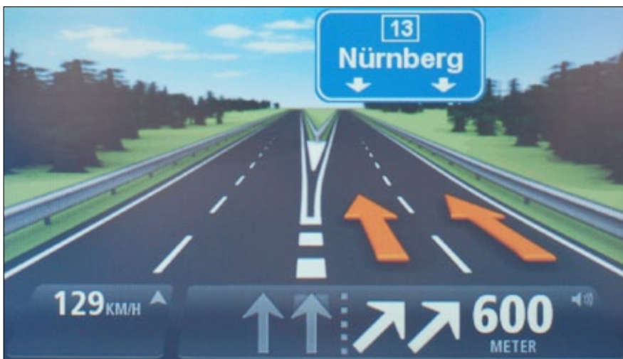
Auf Autobahnen zeigen die aktuellen TomTom-Navis diesen unbewegten, aber dafür recht schnell erfassbaren Fahrspurassistenten.
