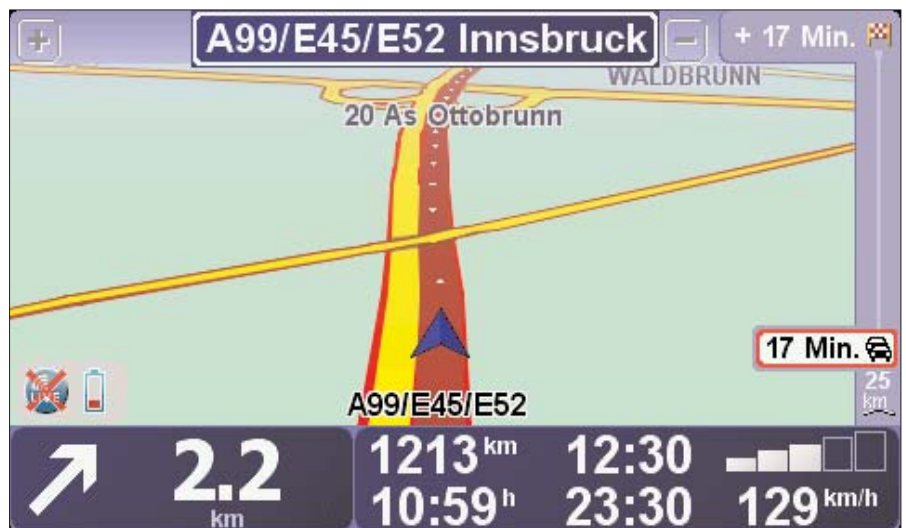
Der Balken rechts hat »Farbe verloren« - tatsächlich ist der Akku bald leer, und dann schaltet das Navi das Datenfunkmodul ab. Damit sind die Meldungen nicht mehr aktuell, was durch die helle Farbe signalisiert wird.
