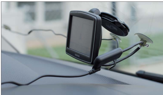
Zugegeben, schön ist die Lösung mit dem externen TMC-Empfänger gar nicht. Aber er empfängt gut.
