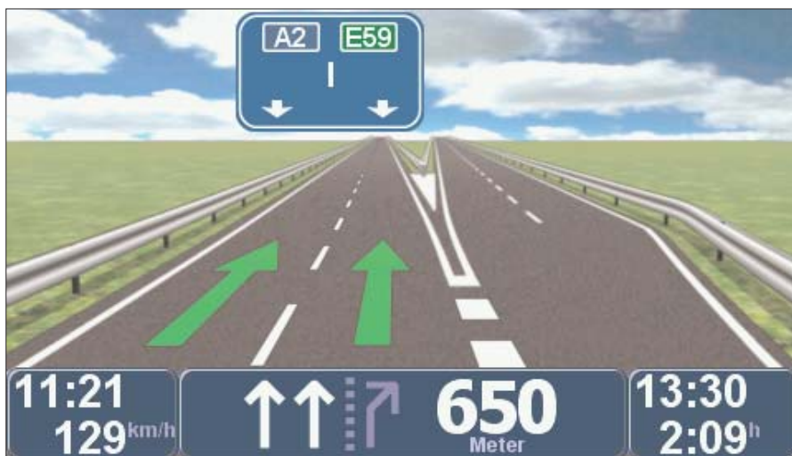
Wir müssen links auf der A2 bleiben. Beachten Sie auch den Fahrspurassistenten im blauen Balken und die Unterschiede des blauen Balkens zum obersten Bild. So sieht er nur aus, wenn Platz gebraucht wird für den Fahrspurassistenten.
