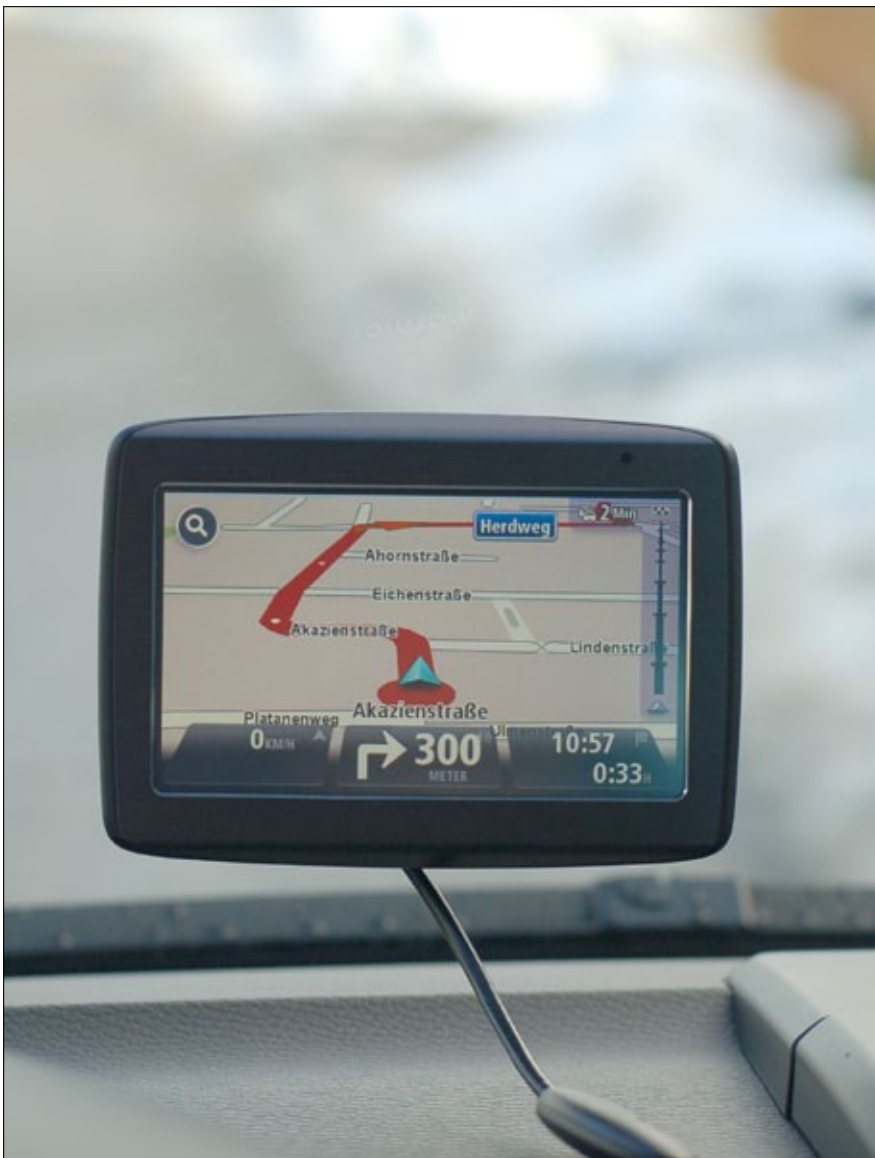
Das TomTom Via 120 Traffic ist mit einem im Ladekabel eingebauten TMC-Empfänger, dem dicken Ei am unteren Bildrand, ausgerüstet.
