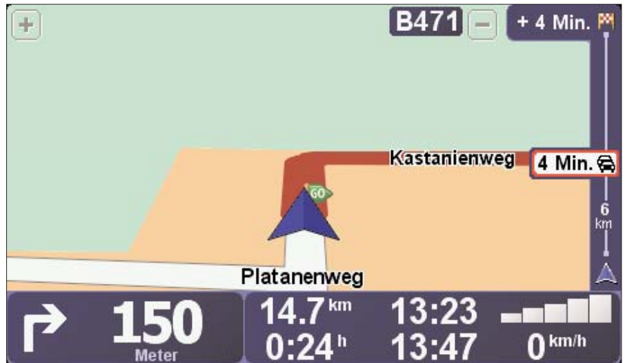
Deutlich erkennt man die im rechten senkrechten blauen Balken die empfangene Verkehrsbehinderung mit vier Minuten Dauer. Falls mehrere Verzögerungen auftreten, addiert das Navi die gesamte Verzögerung und zeigt sie rechts oben.
