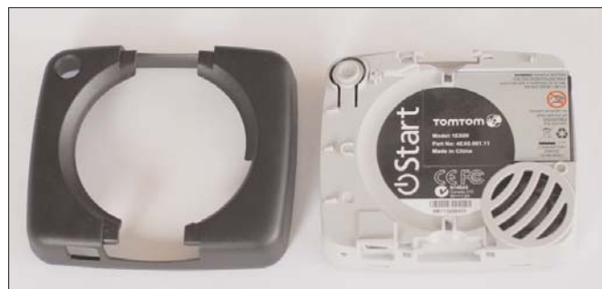
Ohne Wechselschale sollte man das Gerät nicht betreiben. Unter dem Aufkleber mit dem roten Warnsignal liegt der Akku.
