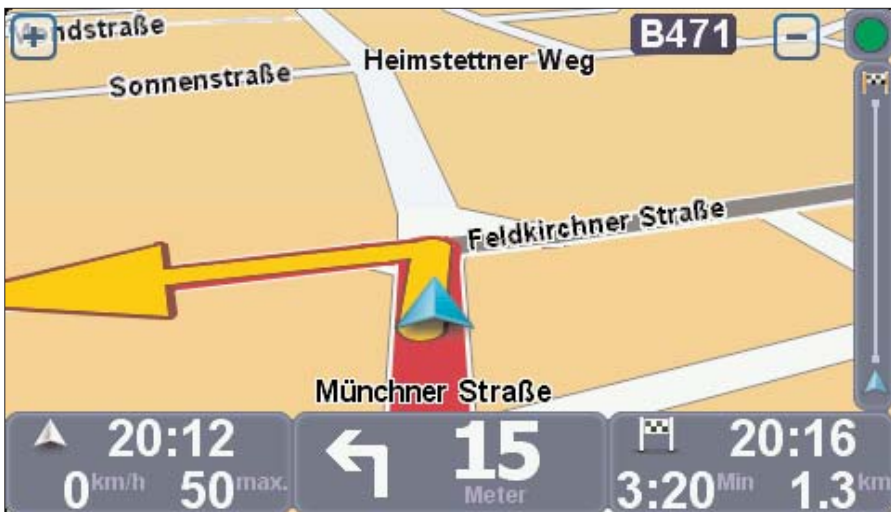
Der automatische Zoom passt den Maßstab der Kartenanzeige in Abhängigkeit von der Geschwindigkeit und vom weiteren Streckenverlauf automatisch an.
