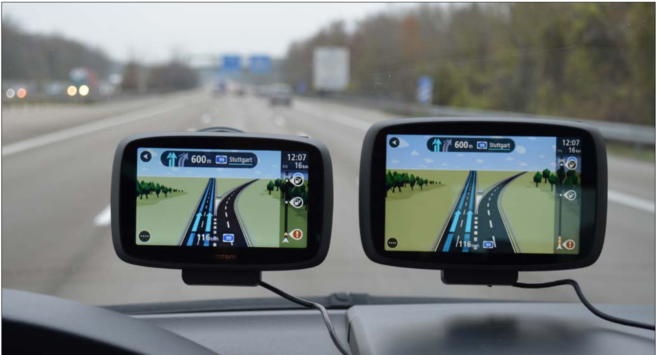
Unten in der Mitte zeigen die Geräte die aktuelle Geschwindigkeit. In dem stehenden Balken rechts findet man Warnhinweise und Sonderziele, die auf dem Weg liegen.
