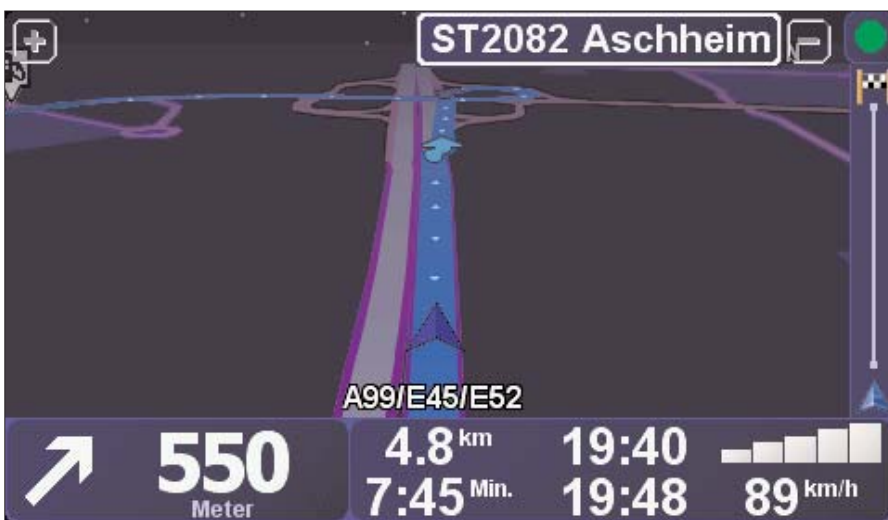
Auf den dunkleren Nachtmodus schaltet das Navi automatisch um. Gleichzeitig wird die Stärke der Hintergrundbeleuchtung gesenkt, damit der Fahrer nicht geblendet wird.
