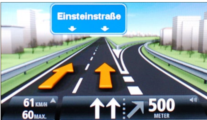
Auf Autobahnen zeigt das TomTom Go Live 1000 diesen unbewegten, aber dafür recht schnell erfassbaren Fahrspurassistenten.
