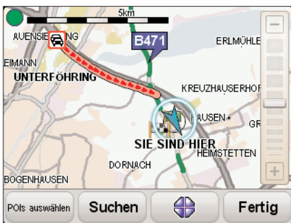
Hier hat das Navi über TMC von einem Stau auf dem Autobahnring A99 erfahren.
