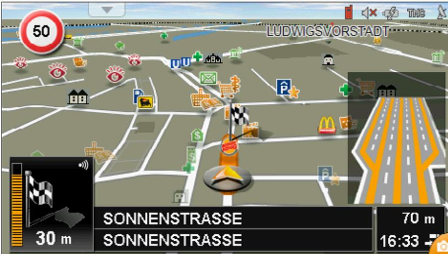
Jetzt wird's mehrspurig: Der Fahrstreifenassistent will uns zur nächsten Kreuzung leiten, und da führen logischerweise alle fünf Spuren hin. Drücken wir auf eines der Sonderziel-Icons, öffnet sich ein Fenster, in dem wir dieses als Zwischenziel definieren können.
