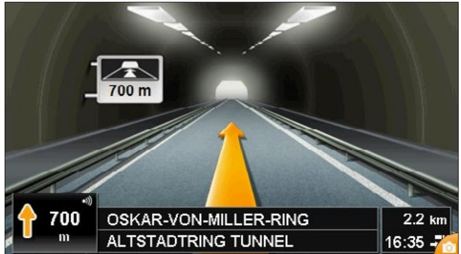
Sobald man in einen Tunnel fährt, schaltet das Navi um auf diesen Modus: Die Entfernungsanzeige rechnet dann einfach mit dem bisherigen Tempo weiter.
