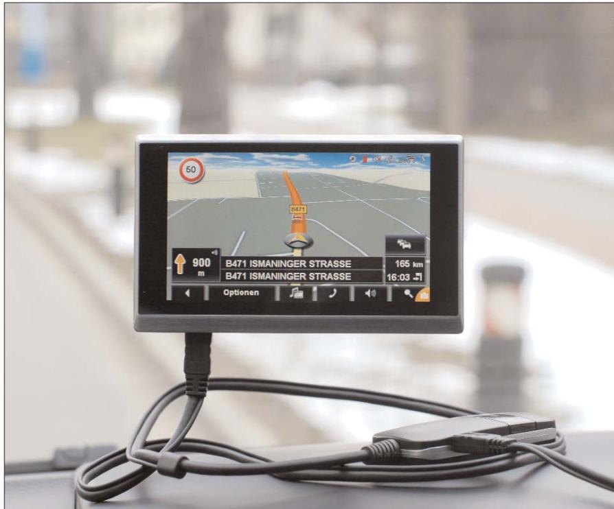
Das Navigon 8450 mit dem externen Live-Modul. Man steckt zuerst das Ladekabel an das Live-Modul und verbindet dessen Kabel dann mit dem Navi. Die Kabellänge ist unseres Erachtens unglücklich gewählt: Zum Verstauen des Live-Moduls auf dem Armaturenbrett ist es zu lang, aber zum »verstecken« des Moduls ist es wiederum zu kurz. Weil der Mini-USB-Stecker zum Navi extrem starr ist, hängt das Navi zwangsweise immer fünf Zentimeter in der Luft. Ein abgewinkelter Stecker wäre hier wesentlich sinnvoller.
