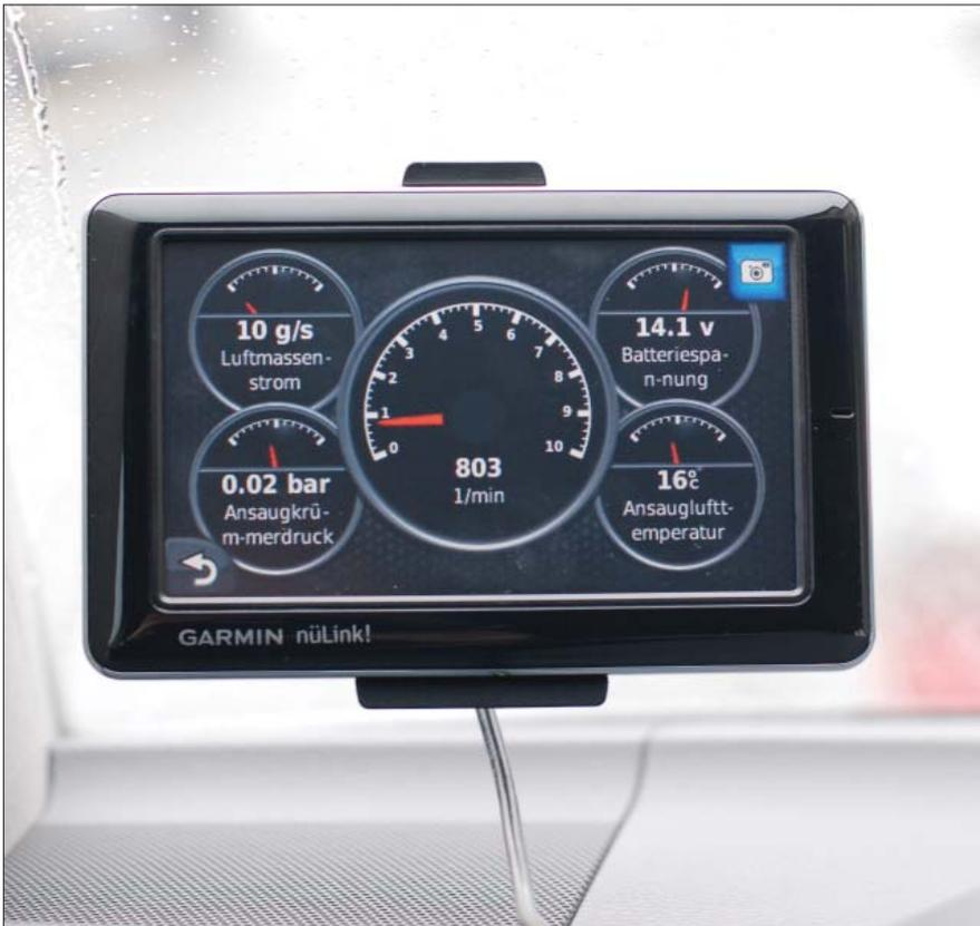
Ein passendes Garmin nüvi wird mit dem EcoRoute-HD-Modul zum vollwertigen Bordcomputer, der sich alle Daten digital aus dem Steuernetzwerk des Fahrzeugs holt.
