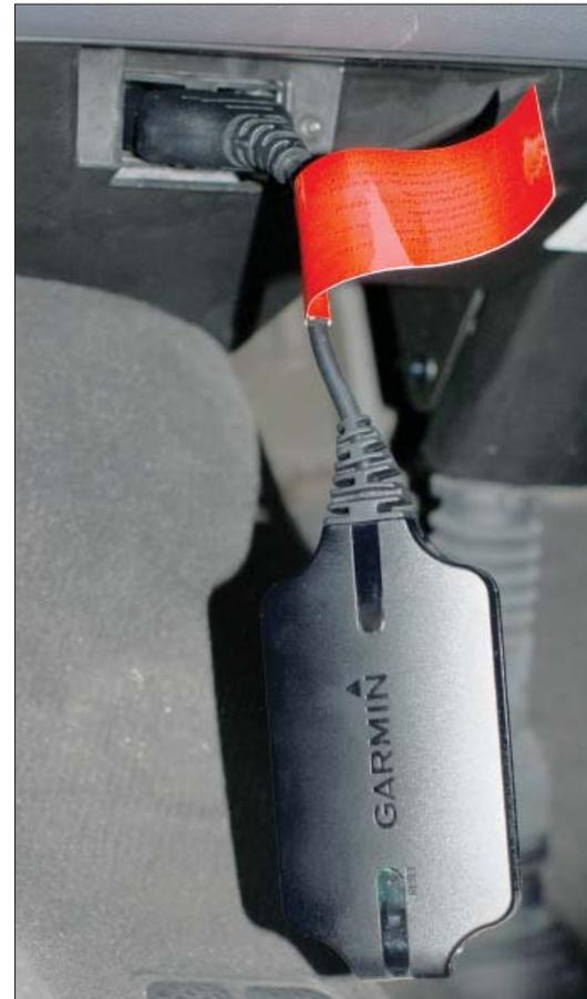
Das EcoRoute-HD-Modul steckt man einfach an den OBD-II-Anschluss, der sich fast immer irgendwo im Fußraum des Fahrers befindet. Nicht vergessen, es ordentlich zu fixieren!
